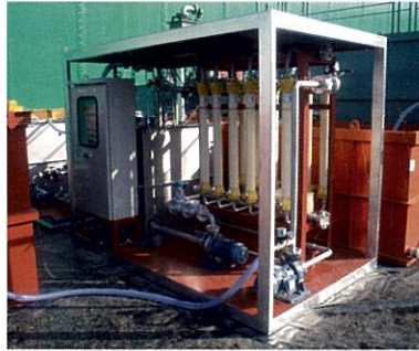
■処理装置（処理能力:5m 3 /hr）
